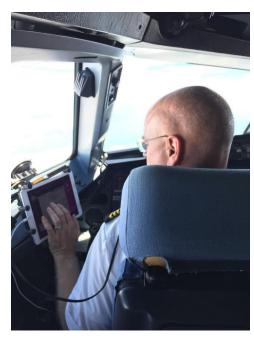
Peach では、タブレットを利用した EFB を活用し、操縦室内で使用する紙マニュアル類をデジタル化することで、タブレット上で迅速にマニュアルの変更を運航乗務員に周知することができるほか、離発着時の機体性能をコンピューター計算することにより、運航効率の最適化を実現します。
